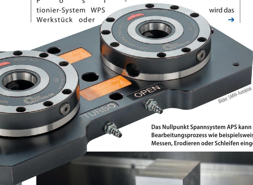
Das Nullpunkt Spannsystem APS kann im kompletten Bearbeitungsprozess wie beispielsweise Drehen, Fräsen, Messen, Erodieren oder Schleifen eingesetzt werden.
